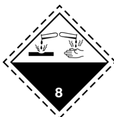
Clase 8: Sustancia corrosiva
