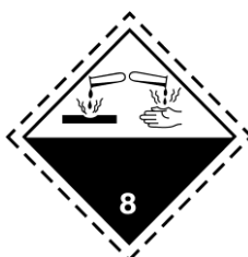
Clase 8: Sustancia corrosiva
