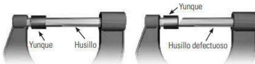
Figura 7. Paralelismo de las superficies de medición.
