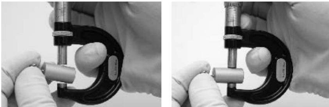
Figura 9. Contacto correcto entre el micrómetro y la pieza a medir
