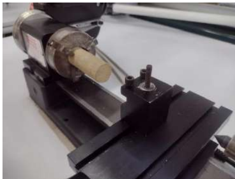
Figura 21. Montaje de pieza y torreta en el torno
