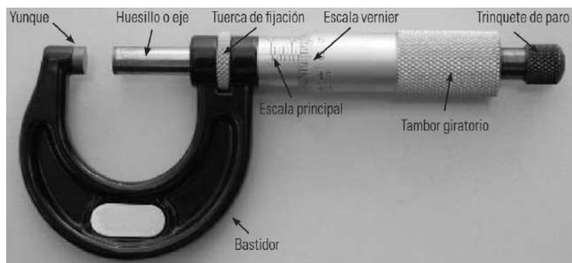
Figura 4. Partes de un micrómetro[5]
