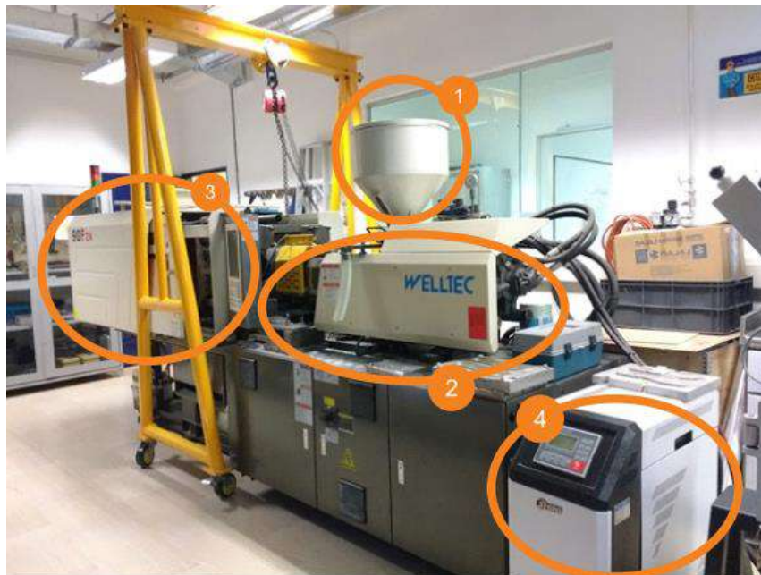
Figura 6. Inyectora ubicada en el laboratorio de polímeros parque i ITM. 1) Unidad de alimentación, 2) Unidad de inyección y 3) Unidad de cierre.
