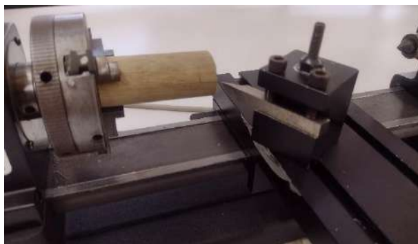
Figura 22. Portaherramientas y buril en carro móvil a 30^\circ
