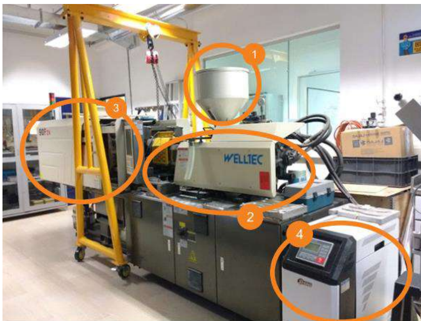
Figura 6. Inyectora ubicada en el laboratorio de polímeros parque i ITM. 1) Unidad de alimentación, 2) Unidad de inyección y 3) Unidad de cierre.
