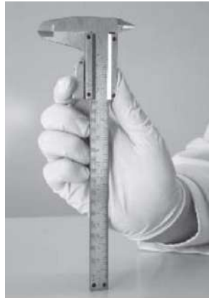
Figura 3. Verificando el medidor de profundidad[3].
