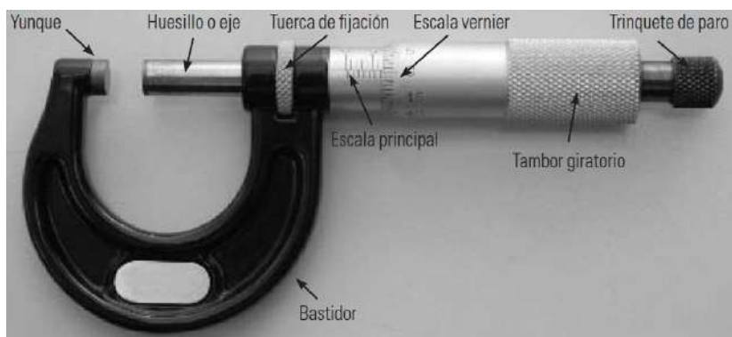
Figura 4. Partes de un micrómetro[5]
