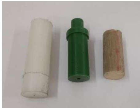
Figura 19. Muestras para mecanizar (refrentado y cilindrado)
