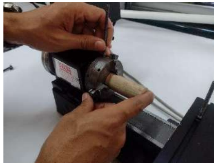
Figura 20. Montaje y ajuste de pieza en el cabezal
