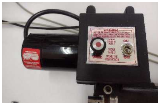
Figura 24. Variador de velocidad y perilla de encendido - apagado del motor del cabezal
