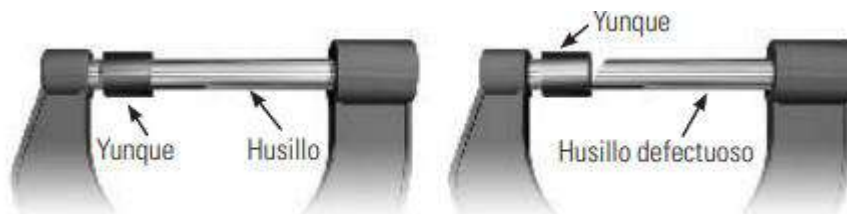
Figura 7. Paralelismo de las superficies de medición.
