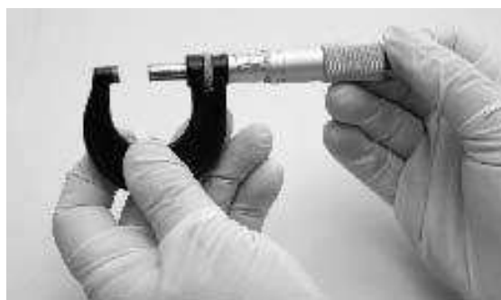
Figura 5. Método correcto para sujetar el micrómetro con las manos[5].
