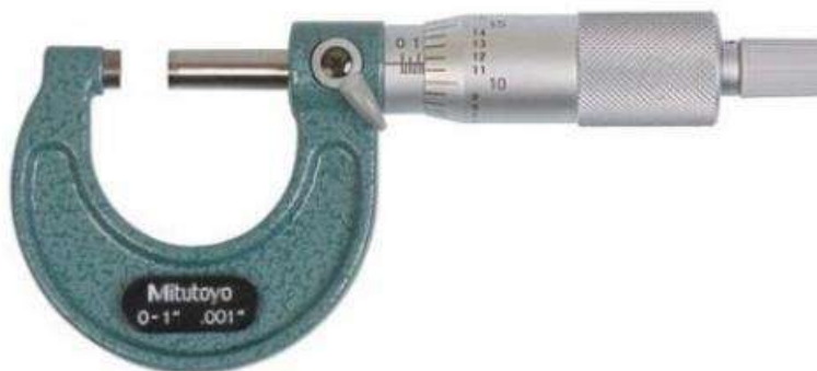
Figura 1. Micrómetro externo con precisión de 0.001”
