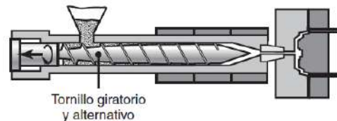
Figura 3. Acumulación de polímero frente a bebedero.
