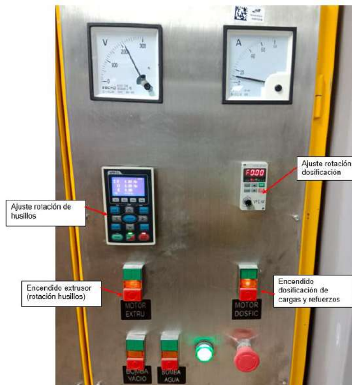
Figura 7. Programación del proceso de extrusión en panel de control
