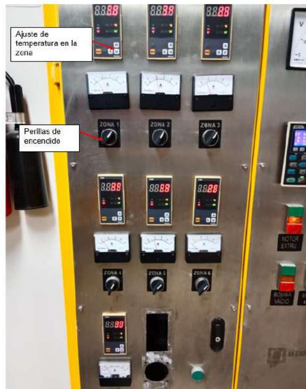
Figura 6. Programación de temperatura en la extrusora
