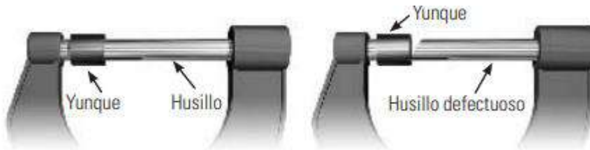
Figura 4. Paralelismo de las superficies de medición.
