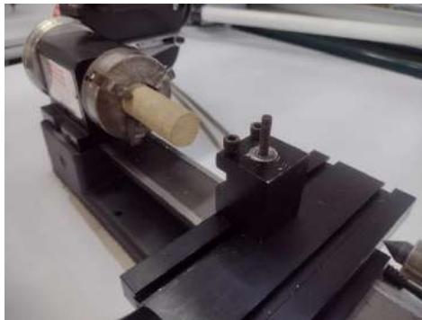
Figura 21. Montaje de pieza y torreta en el torno
