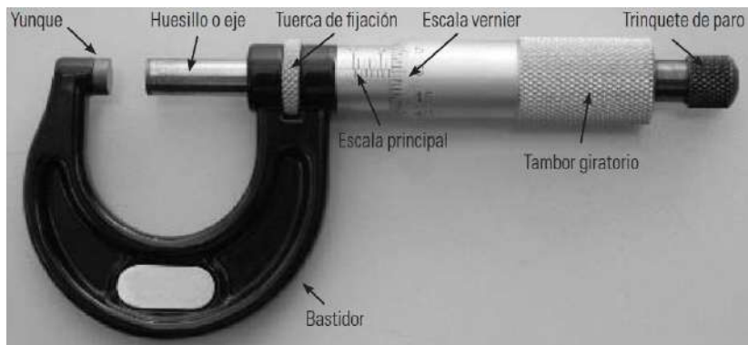
Figura 1. Partes de un micrómetro[2]
