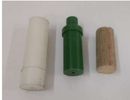
Figura 19. Muestras para mecanizar (refrentado y cilindrado)
