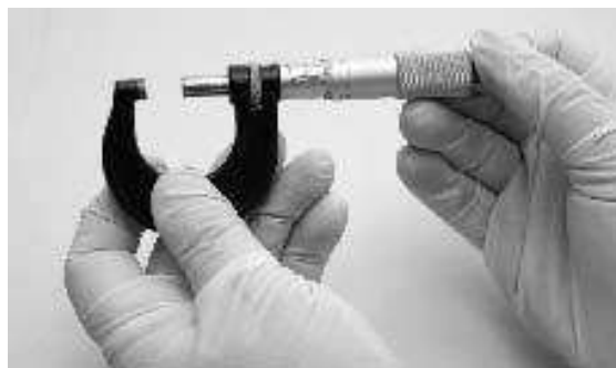
Figura 2. Método correcto para sujetar el micrómetro con las manos[2].
