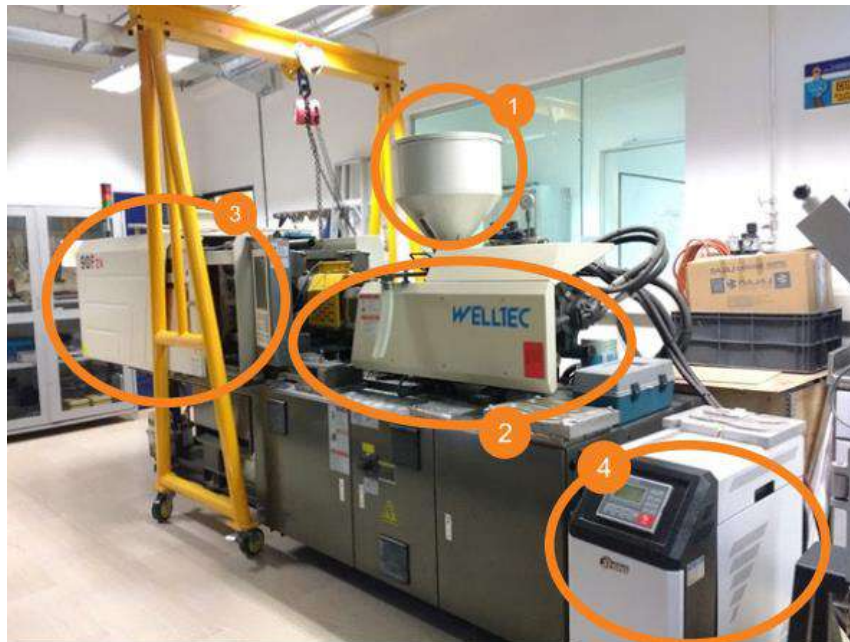
Figura 3. Inyectora ubicada en el laboratorio de polímeros parque i ITM. 1) Unidad de alimentación, 2) Unidad de inyección y 3) Unidad de cierre.
