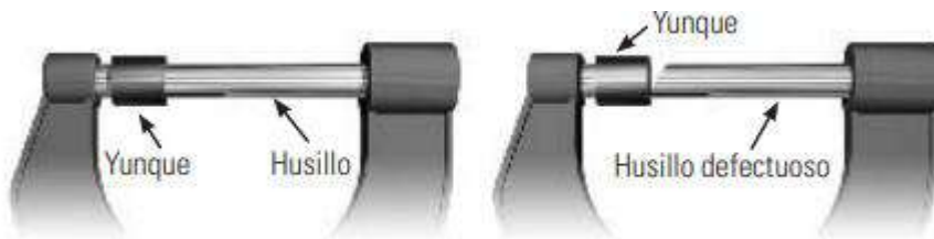
Figura 4. Paralelismo de las superficies de medición.
