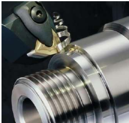
Figura 1. Arranque de viruta con máquina herramienta torno
